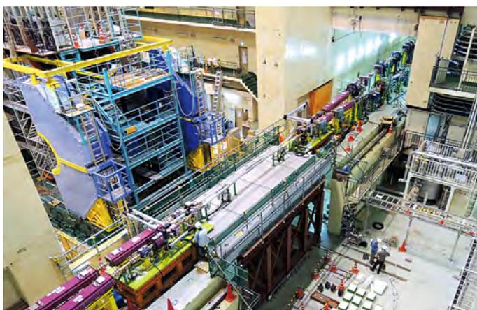
(平成27年7月22日撮影) スーパーKEKB加速器衝突点。左はBelle II測定器(右側の衝突点に移動する)。
