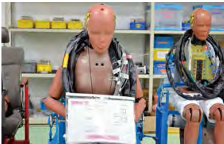
衝突実験用のダミー人形（大きさや体重は人間と全く同じようにできている）
