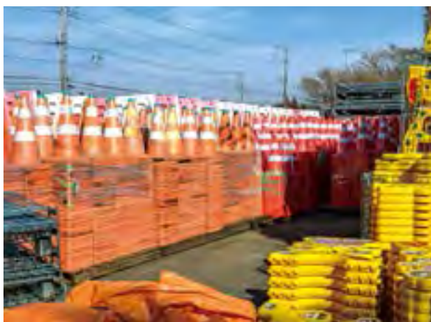
カラーコーン、整然と積まれています。右側の黄色は単管バリケードに使うマスコットキャラクターのキリンガードでしょうか。
